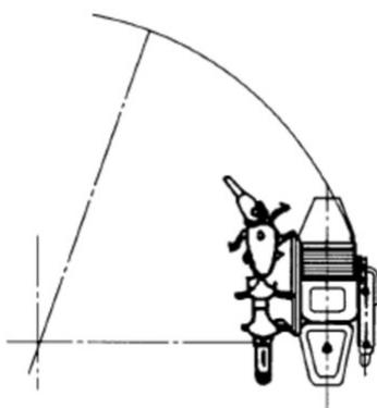
b) 三轮摩托车转弯圆
