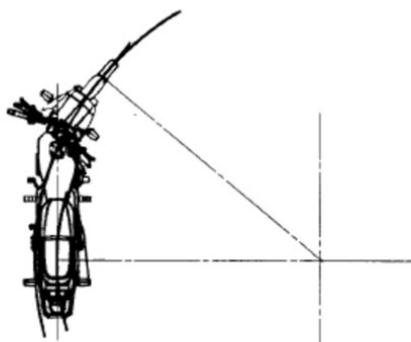
a) 两轮摩托车转弯圆
